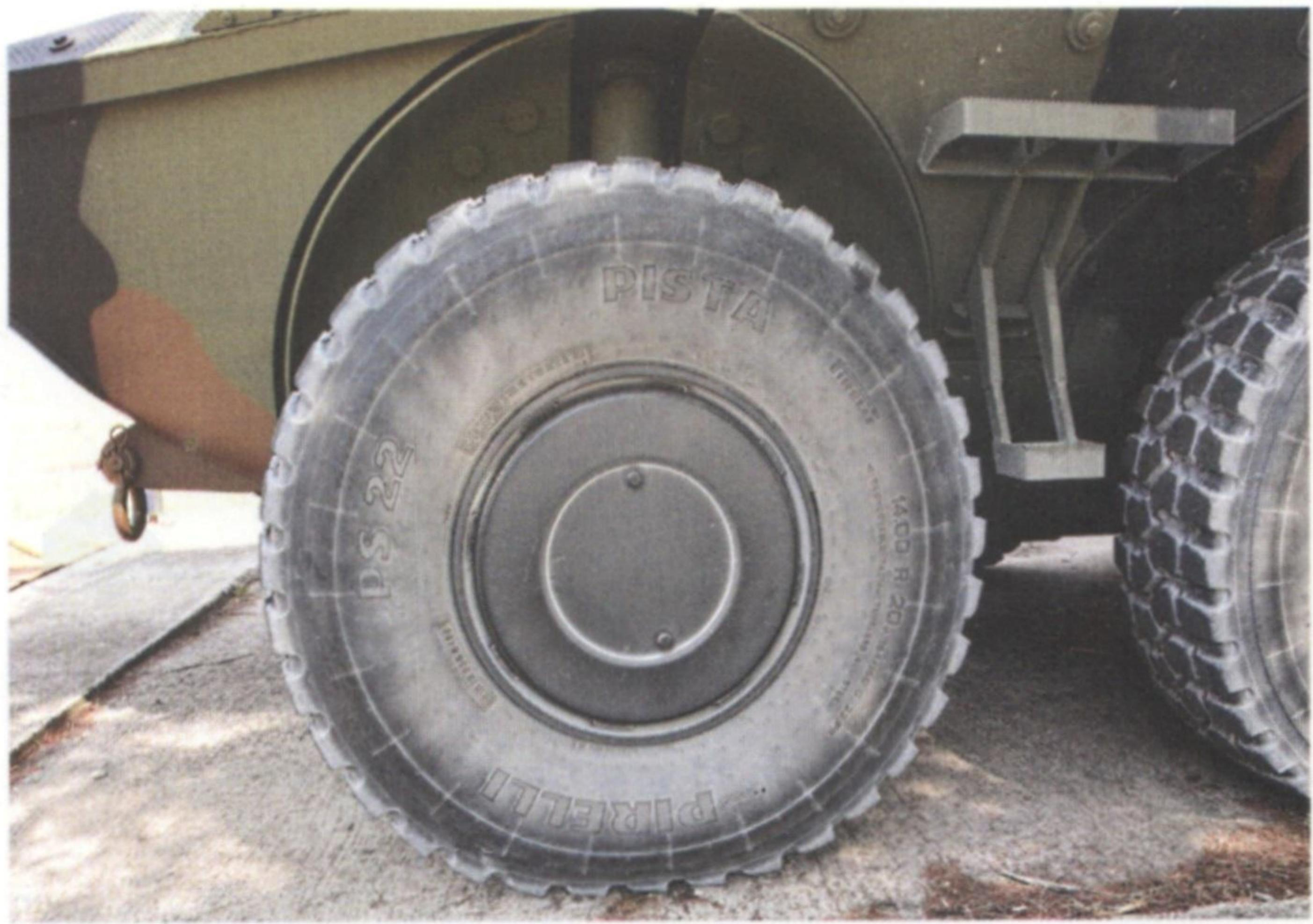
**Un primo piano di uno degli pneumatici della CENTAURO II. Sul veicolo sono montati quelli standard dell'EI tipo 14.00 R20, ma possono essere montati pure i più grandi 415/80 R685. (foto: Autore)**
