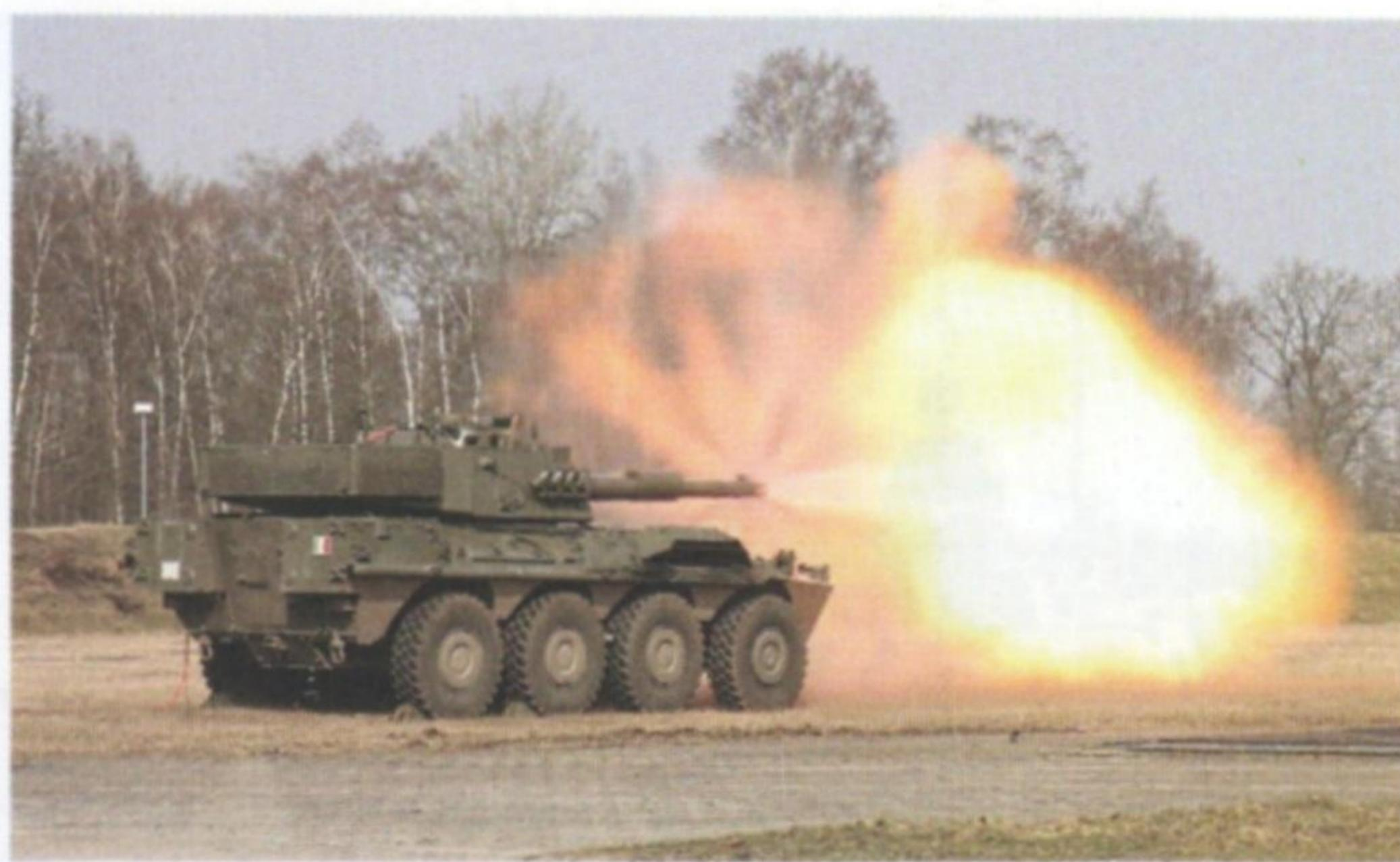
**Una sequenza di fuoco del cannone ad anima liscia da 120/45 mm nel corso di un ciclo di prove ad Unterluss in Germania. (foto: Rheinmetall)**
