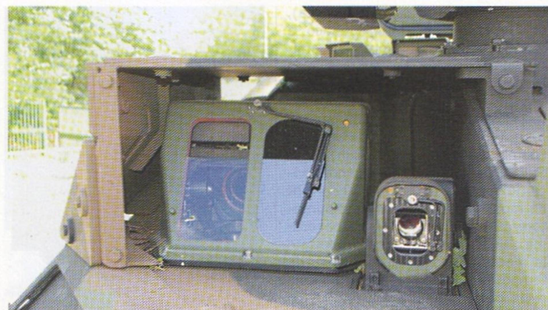
**Primo piano dei 2 sistemi di puntamento del cannoniere: si tratta del LOTHAR SD (a sinistra) ed dell'ottica di backup (a destra). Tali apparati sono protetti, sul lato e superiormente, da alcune piastre di blindatura. (foto: Autore)**
