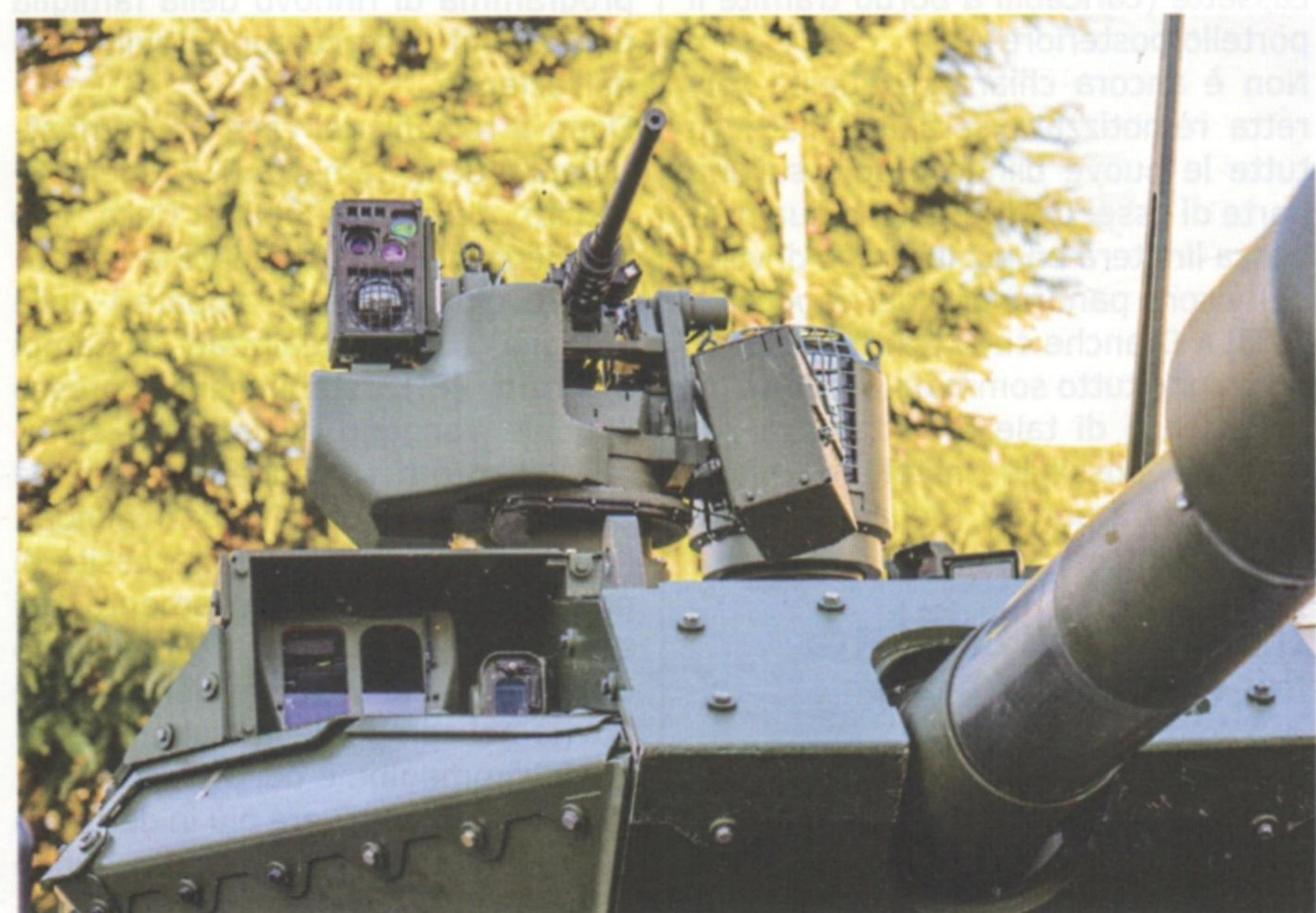
è costituita da 3 elementi: uno "spall liner" interno, una struttura di base (base armor) e apposite piastre aggiuntive (add on armor).
